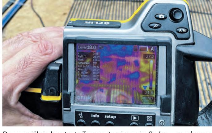
Das ganzjährig konstante Temperaturniveau im Boden – zu erkennen mit der Wärmebildkamera – ermöglicht ein effizientes Heizen.
